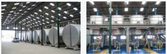
ถังเก็บน้ำมันหล่อลื่นพื้นฐานและถังผสม ภายในโรงงานซันสยามปทุมธานี บนพื้นที่ 10 ไร่
